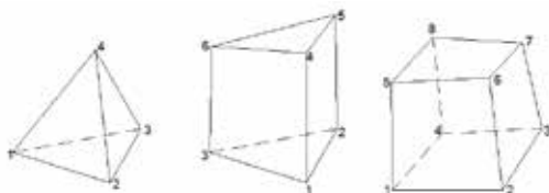
Hình 10. Phần tử tứ diện, phần tử dạng nêm và phần tử lục diện
