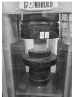
Hình 4. Nén thí nghiệm kiểm tra cường độ bê tông
