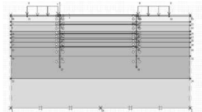
Hình 5. Mô hình tính toán tường vây Bê tông cốt thép bằng Plaxis
