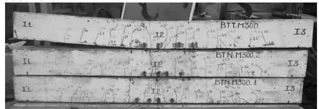
Hình 3. 4. Phân bố các vết nứt trên dầm BTN và dầm BTT
