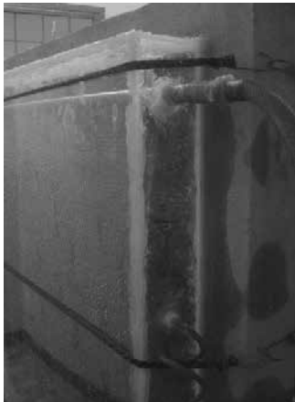
Hình 4. Thí nghiệm thấm tường của khối xây bằng gạch đất sét nung thực hiện theo ASTM E514
