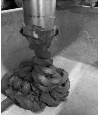
Hình 2. Kiểm tra khả năng đùn bê tông qua vòi in trước khi thực hiện in 3D
