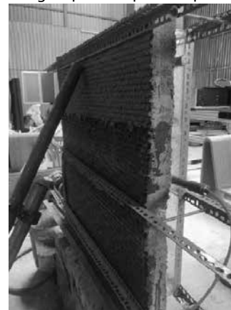
Hình 6. Nước thấm qua tường bê tông in 3D trong quá trình thí nghiệm thực hiện theo ASTM E514
