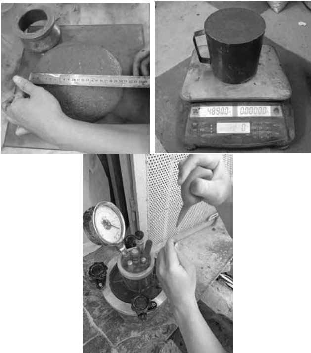
Hình 4. Các thử nghiệm liên quan đến tính công tác của các mẫu hỗn hợp UHPC/RHA-SF
