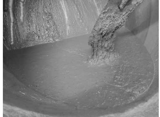
Hình 2. Thiết bị trộn tăng cường UHPC tốc độ cao tại phòng thí nghiệm. Các mẫu thí nghiệm tính chất cơ lý có kích thước như sau:
