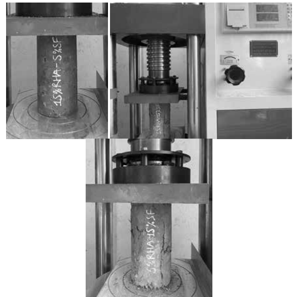
Hình 5. Mẫu nén và kiểm tra cường độ chịu nén của các mẫu UHPC/RHA-SF
