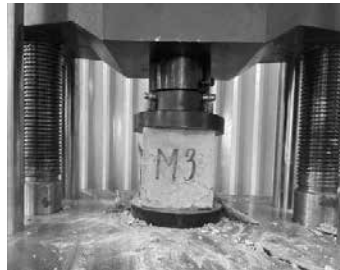
Hình 4. Nén mẫu bê tông
