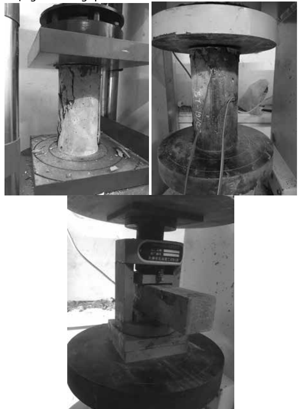
Hình 5 - Thử nghiệm cường độ chịu nén của các mẫu UHPC
